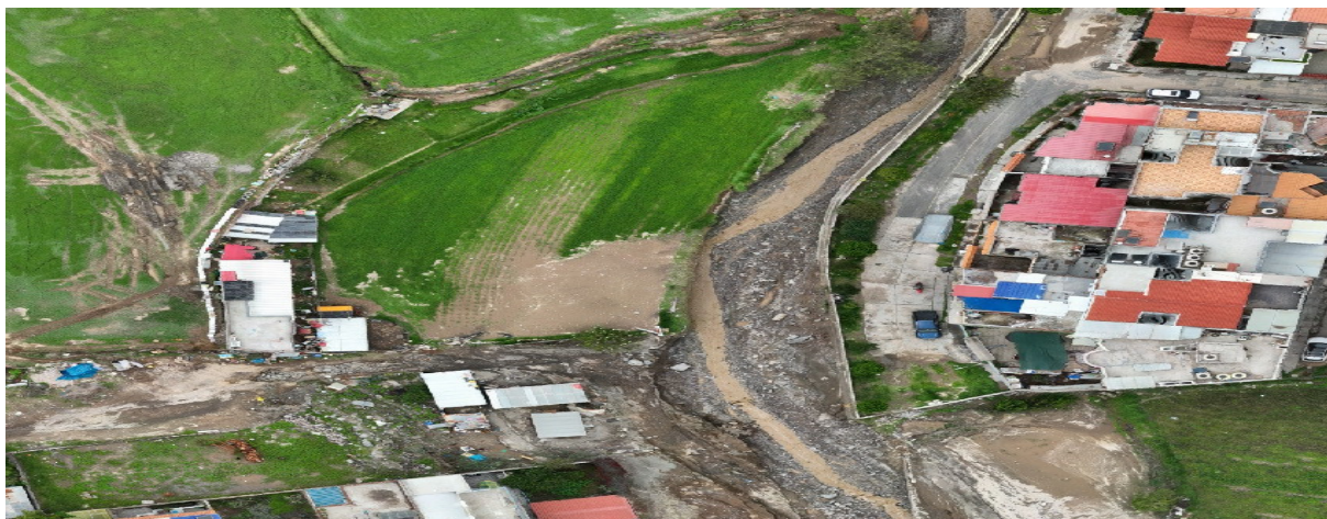
IMAGEN 01: SE OBSERVA LA QUEBRADA COLMATADA CON EROSION EN EL MURO DE CONCRETO Y DESBORDE AGUAS ABAJO
