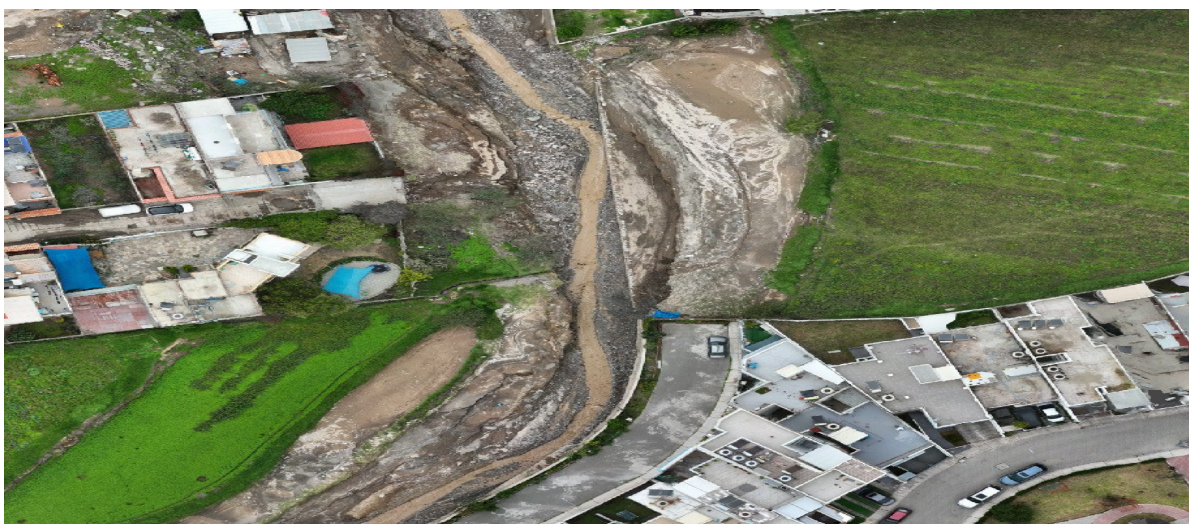
IMAGEN 03: LA VISTA SATELITAL ACTUAL MUESTRA LA EROSION POR FLUJO DE DETRITOS EN LA MARGEN IZQUIERDA DE LA QUEBRADA CHULLO
